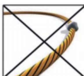
фиксация на клей повредит кабель
