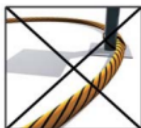
кабель соприкасается со сторонними предметами
