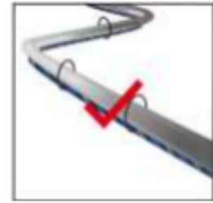
прокладка кабеля вдоль труб
