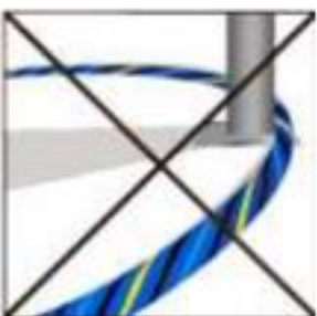
кабель соприкасается со сторонними предметами
